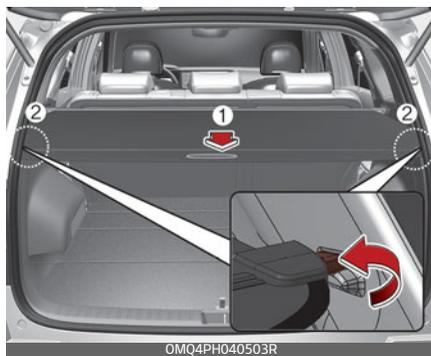
1. Потяните защитный экран для груза в сторону задней части автомобиля за ручку (1).
