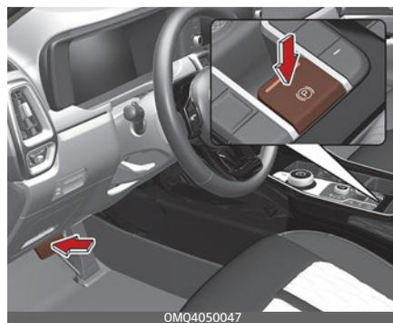
Отключение парковочного тормоза с помощью переключателя EPB,
