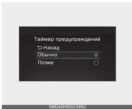
Переведите кнопку «ENGINE START/STOP» (Запуск/остановка двигателя) в положение «ON» (Вкл.) и в меню «Settings» (Настройки) выберите пункты «Driver Assistance» (Помощь водителю) → «Warning Timing» (Таймер предупреждений), чтобы изменить первоначальную скорость выдачи предупреждений системы предотвращения лобового столкновения.
