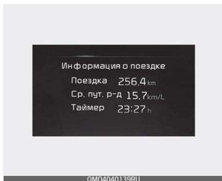
В режиме маршрутного компьютера отображается информация, связанная с параметрами движения автомобиля, включая расход топлива, показания одометра и таймера.
