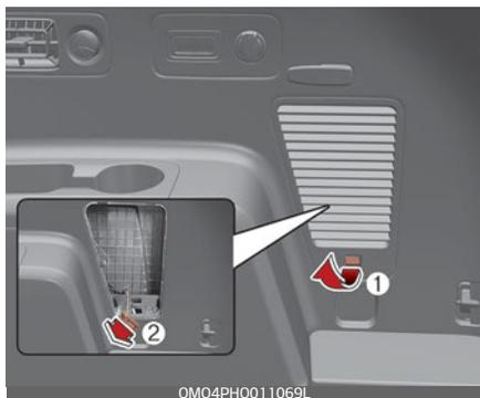
Если не удастся отсоединить разъем зарядного кабеля вследствие разряда батареи и/или неисправности электросистемы, откройте крышку (1) справа от багажного отделения и слегка потяните аварийный кабель (2). Разъем зарядного кабеля отсоединится.
