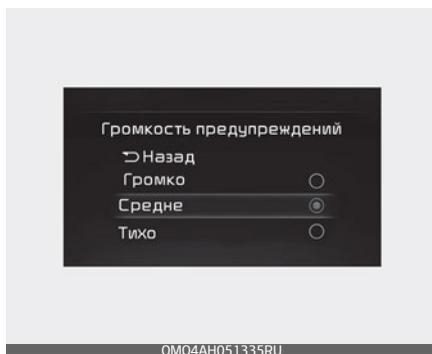
Переведите кнопку «ENGINE START/STOP» (Запуск/остановка двигателя) в положение «ON» (Вкл.) и в меню «Settings» (Настройки) выберите пункт «Driver Assistance» (Помощь водителю) → «Warning Volume» (Громкость предупреждений). Здесь можно настроить громкость предупреждений для системы предупреждения об отсутствии рук на руле. Для этого выберите одно из значений «High» (Высокая), «Medium» (Средняя), «Low» (Низкая) и «Off» (Выкл.).
