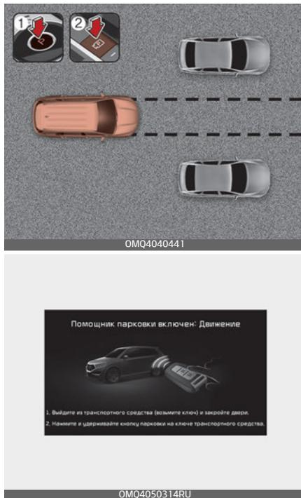
1. Остановите автомобиль перед местом, где будет использоваться функция дистанционного движения вперед/назад и передвиньте рычаг коробки передач в положение «Р» (парковка).
