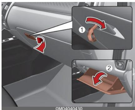
Перчаточный ящик можно запирать и отпирать с помощью механического ключа (1).
