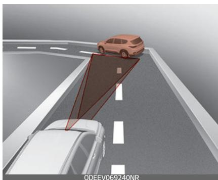
Скорость автомобиля, может быть снижена с учетом транспортного средства в соседней полосе движения.
