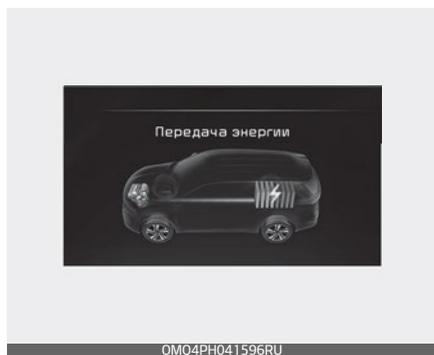
Если автомобиль остановлен, аккумулятор высокого напряжения заряжается от двигателя.
