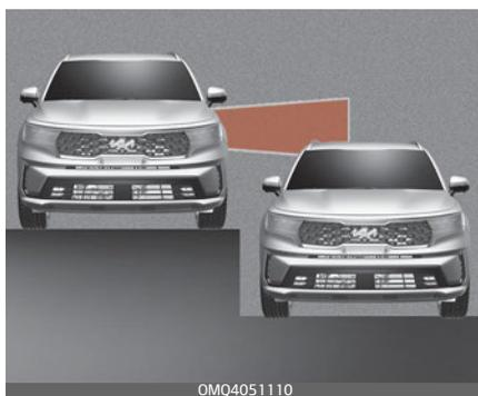
Система контроля «мертвых» зон может работать некорректно при движении в местах, где полосы расположены на разной высоте.
