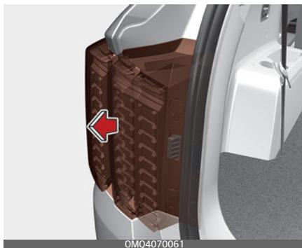
5. Извлеките узел задней комбинированной фары из кузова автомобиля.
