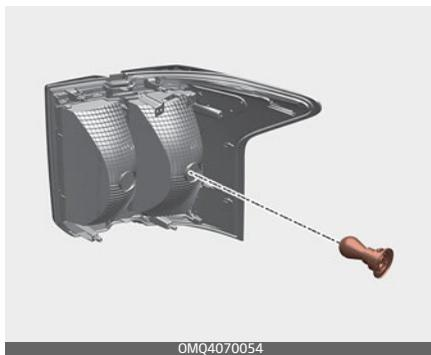
8. Извлеките лампу из патрона, вдавив ее и повернув против часовой стрелки до положения, в котором ее выступы совместятся с прорезями в патроне. Выньте лампу из патрона.
