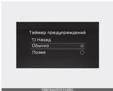
Когда кнопка запуска/остановки двигателя находится в положении «ON» (Вкл.), выберите «Driver Assistance» (Помощь водителю) → «Warning Timing» (Таймер предупреждений) в меню «Settings» (Настройки), чтобы изменить первоначальную скорость выдачи предупреждений для системы контроля внимания.
