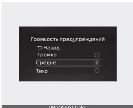
Чтобы изменить уровень громкости системы контроля слепых зон на «High» (Высокий), «Medium» (Средний), «Low» (Низкий) или «Off» (Выкл.), переведите кнопку «ENGINE START/STOP» (Запуск/остановка двигателя) в положение «ON» (Вкл.) и в меню «Settings» (Настройки) выберите пункт «Driver Assistance» (Помощь водителю) → «Warning Volume» (Громкость предупреждения).
