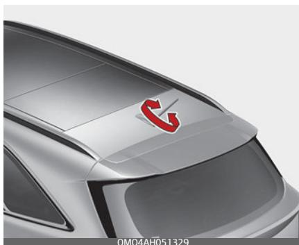
1. Антенна «акулий плавник» (тип А) (при наличии)
