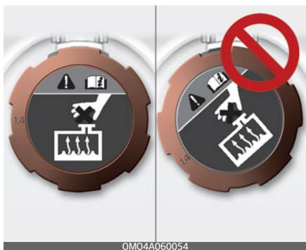
2. Убедитесь, что небольшие выступы внутри крышки заливной горловины охлаждающей
