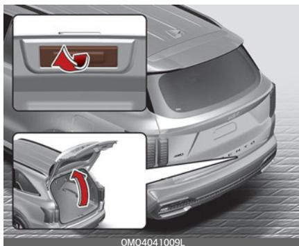
3. Кнопка закрытия двери багажного отделения с электроприводом
