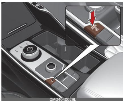
Чтобы отключить обогрев рулевого колеса, нажмите кнопку еще раз. Индикатор на кнопке погаснет.
