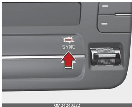
1. Для регулирования температуры на стороне водителя и пассажира нажмите кнопку «SYNC» (Синхронизация).
