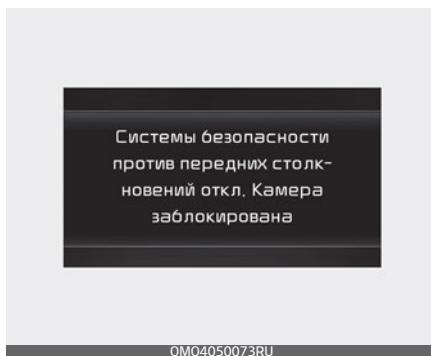
Если лобовое стекло, на котором расположена камера переднего вида, покрыто посторонними веществами, например засыпано снегом или залито дождем, качество обнаружения может снизиться. Кроме того, это может привести к временному ограничению работоспособности или отключению вспомогательной функции предотвращения лобового столкновения.
