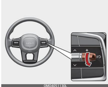
3. Установленное ограничение скорости отображается на приборной панели. Заданное ограничение скорости начнет мигать и прозвучит звуковой сигнал, пока скорость автомобиля не вернется в допустимые пределы.
