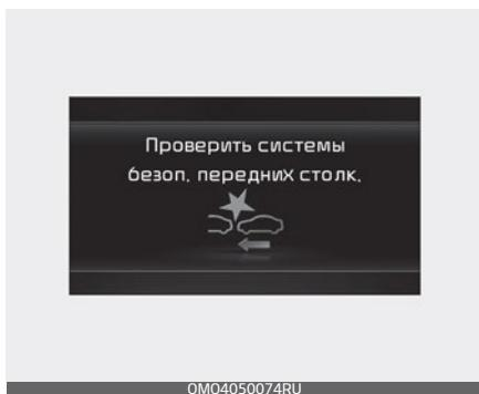
Если система помощи по предотвращению лобового столкновения не работает надлежащим образом, на приборной панели будет выведено предупреждающее сообщение и загорятся сигнальные лампы
