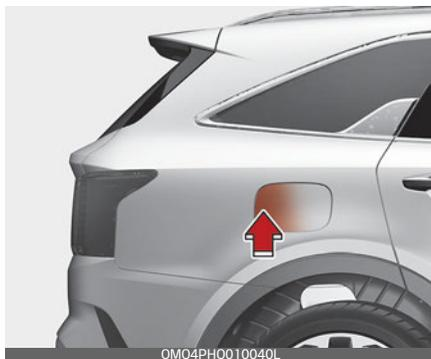
6. Очистите разъем зарядного кабеля и гнездо зарядки автомобиля от пыли.
