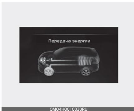
Аккумулятор высокого напряжения заряжается от системы рекуперативного торможения.
