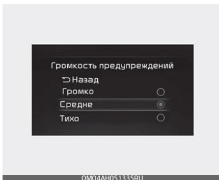
Когда кнопка запуска/остановки двигателя находится в положении «ON» (Вкл.), выберите «Driver Assistance» (Помощь водителю) → «Warning Volume» (Громкость предупреждений) в меню «Settings» (Настройки), чтобы изменить громкость предупреждений для системы помощи по предотвращению переднего столкновения, выбрав одно из значений: «High» (Высокая), «Medium» (Средняя), «Low» (Низкая) или «Off» (Выкл.).
