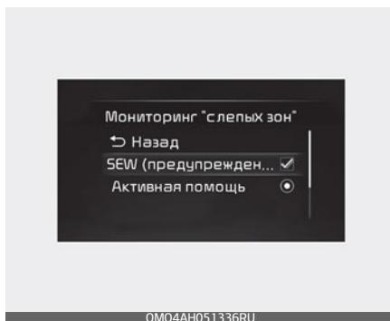
Когда кнопка запуска/остановки двигателя находится в положении «ON» (Вкл.), выберите в меню «Settings» (Настройки) пункт «Driver Assistance» (Помощь водителю) → «Blind-Spot Safety» (Мониторинг слепых зон) → «Safe Exit Warning» (Контроль безопасного выхода), чтобы включить систему контроля безопасного выхода, и отмените выбор для ее отключения.
