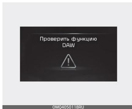
Если система контроля внимания водителя работает неправильно, на приборной панели появится предупреждающее сообщение «Check Driver Attention Warning (DAW) system» (Проверьте систему контроля внимания водителя). В этом случае рекомендуется провести осмотр автомобиля у официального дилера/партнера по обслуживанию Kia.
