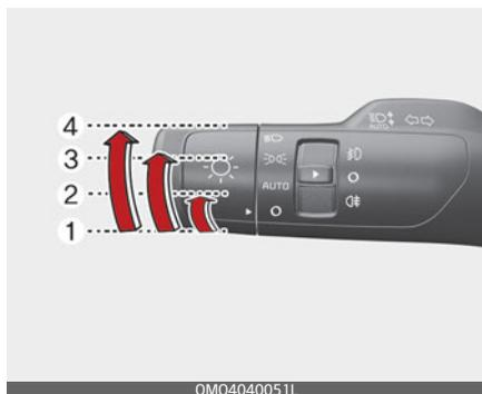
Для регулировки освещения поверните ручку на конце рычага управления в одно из следующих положений.
