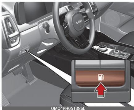
2. Необходимо подождать снижения давления в топливном баке. Это сообщение появляется в том случае, если лючок топливного бака разблокируется после снижения давления в топливном баке.
