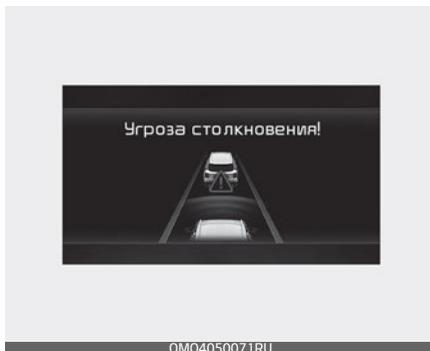
Если работает система интеллектуального круиз-контроля и существует высокий риск столкновения с движущимся впереди транспортным средством, на приборной панели отобразится предупреждающее сообщение «Collision Warning» (Угроза столкновения) и прозвучит звуковое сообщение для оповещения водителя. При движении необходимо постоянно следить за дорожной ситуацией впереди и
