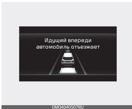
После отъезда автомобиля впереди функция контроля отъезда находящегося впереди автомобиля информирует об этом водителя, выводя на приборную панель сообщение «Leading vehicle is driving away» (Автомобиль впереди
