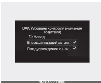
Если включена функция контроля отъезда находящегося впереди автомобиля, система сообщает водителю о начале движения находящегося впереди автомобиля.
