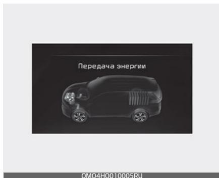
Для приведения автомобиля в движение используется только энергия двигателя.
