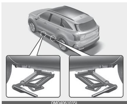
7. Установите домкрат в переднее (1) или заднее (2) подъемное положение (ближайшее к заменяемому колесу). Разместите домкрат под рамой автомобиля в обозначенной точке. Положения для упора домкрата — это приваренные к раме автомобиля пластины с двумя фиксаторами и напльвом.
