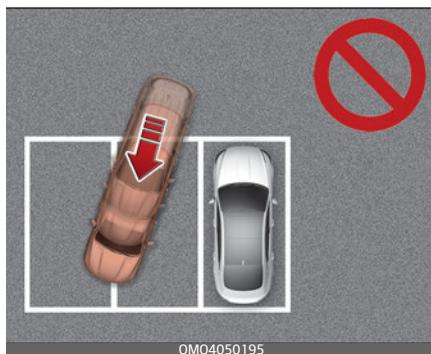
Если при использовании интеллектуальной системы дистанционной парковки другой автомобиль находится только с одной стороны, ваш автомобиль может пересечь парковочную линию во избежание столкновения.
