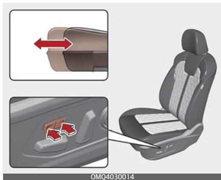
1. Нажмите на переднюю часть переключателя, чтобы поднять удлинитель подушки, или на заднюю, чтобы опустить его.
