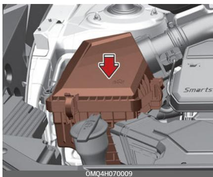
Его можно очистить в процессе проверки отсека воздухоочистителя. Очистите фильтр при помощи сжатого воздуха.
