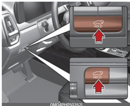
Дверь багажного отделения автоматически закрывается и запирается.
