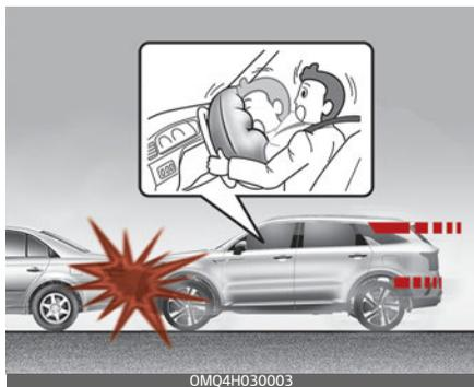
Фронтальные подушки безопасности предназначены для надувания при лобовом столкновении в зависимости от интенсивности, скорости или угла удара.
