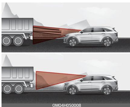
Если впереди идущий автомобиль имеет груз, выступающий сзади за пределы автомобиля, или если автомобиль имеет высокий дорожный просвет, соблюдайте особую осторожность. Система «Forward Collision-Avoidance Assist» (Предотвращение лобового столкновения) может не обнаружить груз, выходящий за габариты транспортного средства. В этих случаях необходимо поддерживать безопасную дистанцию торможения от крайнего объекта и
