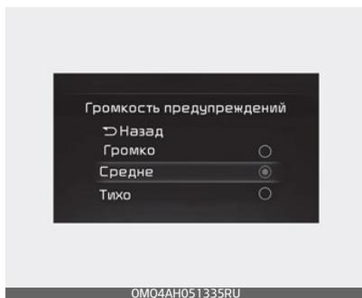
На приборной панели или в информационно-развлекательной системе в меню «Settings» (Настройки) выберите пункт «Driver Assistance» (Помощь водителю) → «Warning Volume» (Громкость предупреждений) и настройте громкость предупреждений для системы предупреждения о расстоянии при парковке задним ходом, выбрав одно из значений «High» (Громко), «Medium» (Средне), «Low» (Тихо) или «Off» (Выкл.).
