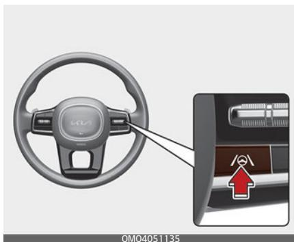
Чтобы включить систему слежения за полосой движения, когда кнопка запуска/остановки двигателя находится в положении «ON» (Вкл.), нажмите расположенную на рулевом колесе кнопку «Lane Following Assist» (Слежение за полосой движения). На приборной панели включится белый или зеленый индикатор (🚦).
