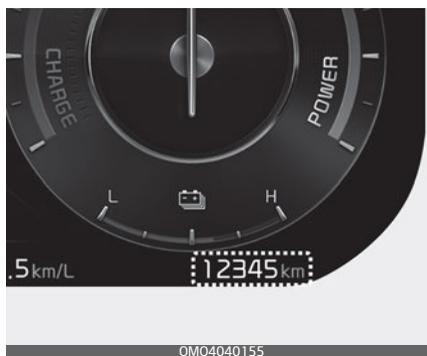
Одометр показывает общее расстояние, которое преодолел автомобиль, и он должен использоваться для определения срока выполнения периодического техобслуживания.
