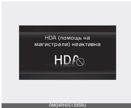
Если водитель не положит руки на рулевое колесо после предупреждения об отсутствии рук на руле, на экране появится предупреждение «Highway Driving Assist (HDA) canceled» (Вспомогательная система движения по автострате [HDA] отменена).
