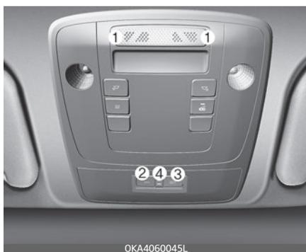
Элементы системы ЭРА-ГЛОНАСС, установленные в салоне автомобиля:
