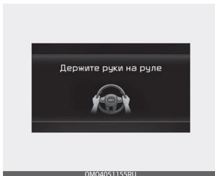
Если водитель снимет руки с рулевого колеса на несколько секунд, на панели появится предупреждающее сообщение «Keep hands on the steering wheel» (Не отпускайте рулевое колесо) и прозвучит несколько предупреждающих звуковых сигналов.
