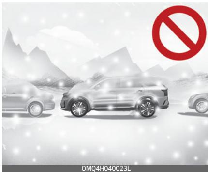
Снег может помешать работе датчиков в процессе парковки, а на скользкой дороге может быть отменена работа интеллектуальной системы дистанционной парковки.
