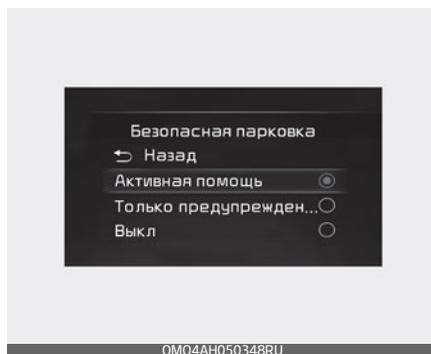
Когда кнопка «Engine Start/Stop» (Запуск/остановка двигателя) находится в положение «ON» (Вкл.), включите или отключите в меню «Settings» (Настройки) пункт «Driver Assistance» (Помощь водителю) → «Parking Safety» (Безопасность парковки) в зависимости от потребности в использовании данной функции.
