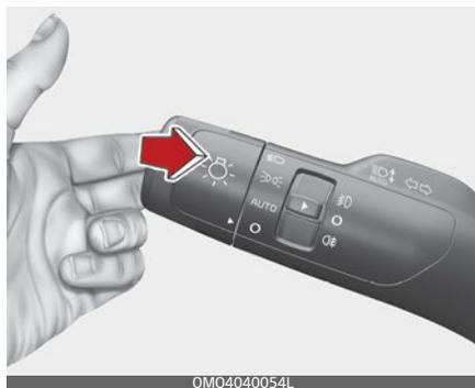
После отпускания рычаг вернется в исходное положение (ближний свет). Для использования функции мигания включение переключателя фар головного света не требуется.
