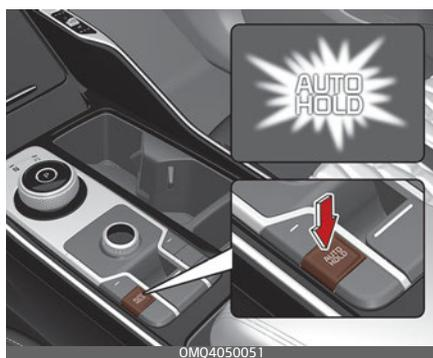
Перед включением «Auto Hold» (Автоматическое удержание) водительская дверь, капот двигателя и дверь багажника должны быть закрыты.
