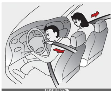
Автомобиль оснащен ремнями безопасности водителя и переднего пассажира с преднатяжителями.
