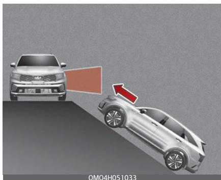
Функция предотвращения столкновения с объектами, движущимися в поперечном направлении позади автомобиля, может быть ограничена при движении автомобиля на подъеме или спуске (или рядом с ними) и может не обнаружить транспортное средство, приближающееся слева и справа. Если это произойдет, функция может не предупредить водителя или не применить тормоза, когда это будет необходимо.
