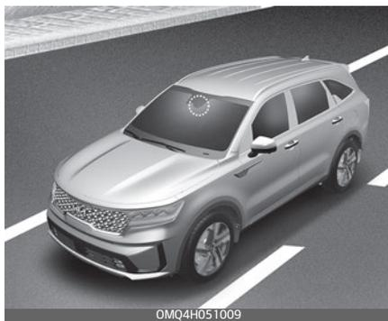
Камера переднего вида используется в качестве датчика обнаружения для определения дорожной разметки (или обочины).
