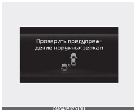
Если индикатор на боковом зеркале работает неправильно, на панели появится предупреждающее сообщение «Check side view mirror warning light» (Проверьте индикатор на боковом зеркале). Проверьте работу функции у официального дилера Kia.
