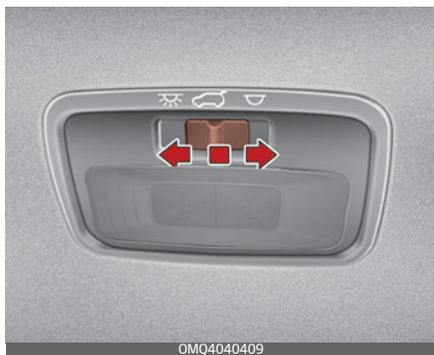
Лампа подсветки багажного отделения загорается при открывании двери багажного отделения.
