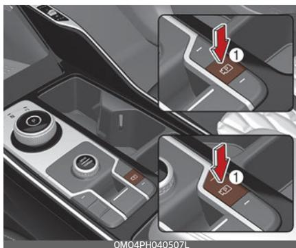
Чтобы включить или выключить монитор заднего вида, нажмите кнопку «Parking/View» (Парковка/обзор) (1).
