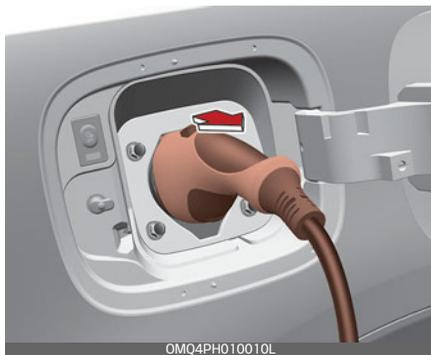
Для предотвращения кражи зарядного кабеля разъем нельзя отсоединить от гнезда, если двери автомобиля заблокированы.
