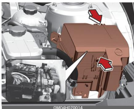
Если не работает пластинчатый плавкий предохранитель, извлеките его с помощью специальных клещей, предназначенных для замены предохранителей, расположенных в блоке предохранителей моторного отделения. После извлечения установите запасной предохранитель аналогичного номинала.
