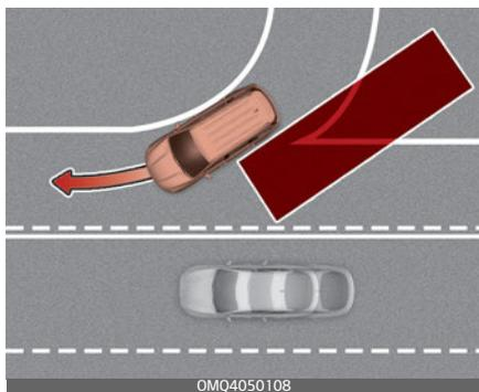
Система контроля «мертвых» зон может работать некорректно при движении в местах соединения или разделения дорог. Функция может не обнаружить автомобиль на соседней полосе.
