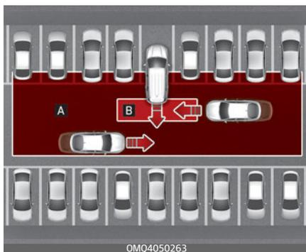
[A]: зона действия системы предупреждения об опасности столкновения с объектами, движущимися в поперечном направлении позади автомобиля
