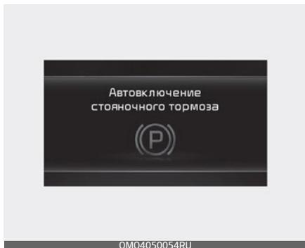
Когда переход с автоматического удержания (Auto Hold) на электронный стояночный тормоз не работает должным образом, раздастся звуковой сигнал и появится сообщение.
