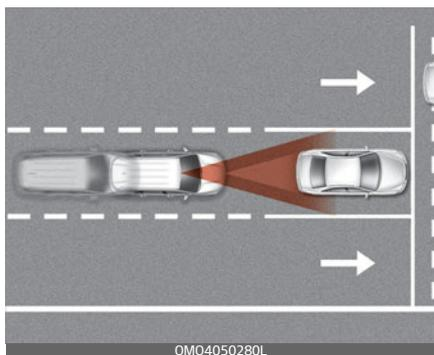
Система помощи по предотвращению переднего столкновения помогает обнаруживать и отслеживать транспортные средства по ходу движения, обнаруживать пешеходов или велосипедистов на проезжей части, а также предупреждает водителя о возможном столкновении с помощью предупреждающего сообщения и звукового оповещения и при необходимости применения экстренного торможения.
