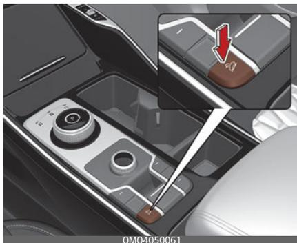
Система помощи при спуске (DBC) упрощает движение вниз по крутому уклону, позволяя не пользоваться при этом педалью тормоза.
