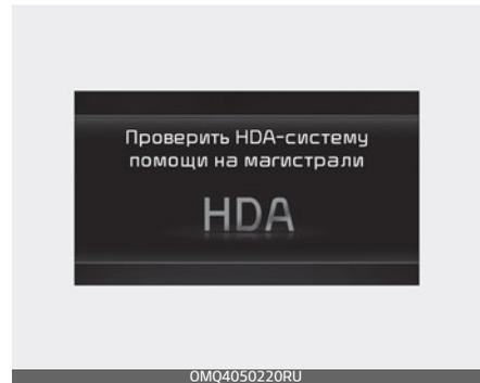
Если вспомогательная система движения по автомагистрали работает некорректно, на приборной панели на несколько секунд будет выведено предупреждающее сообщение «Check Highway Driving Assist (HDA) system» (Проверьте вспомогательную систему движения по автомагистрали) и загорится индикатор (⚠️). Проверьте работу функции у официального дилера Kia.
