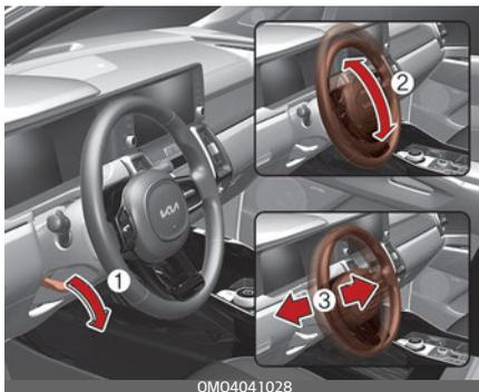
1. Чтобы изменить угол наклона рулевого колеса, потяните рычаг блокировки (1) вниз.
