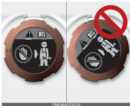
2. Убедитесь, что небольшие выступы внутри крышки заливной горловины охлаждающей жидкости инвертора надежно зафиксированы.
