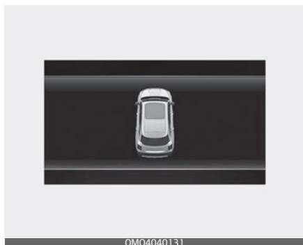
Если выключить двигатель при не полностью закрытом люке в крыше, через несколько секунд начнет звучать предупреждающий сигнал, а на ЖК-дисплее приборной панели появится предупреждающее сообщение об открытом люке в крыше.
