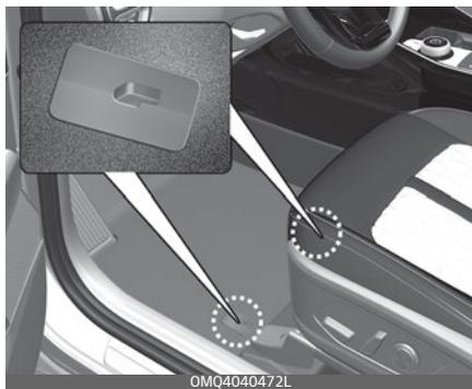
При использовании напольного коврика на напольном покрытии под передним сиденьем закрепите его с помощью специальных фиксаторов. Это позволит предотвратить соскальзывание коврика вперед.
