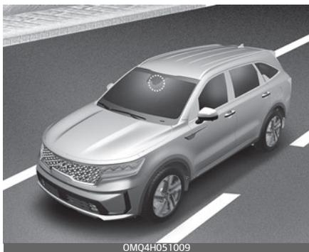
Камера переднего вида используется в качестве датчика обнаружения дорожной разметки и движущихся впереди автомобилей.
