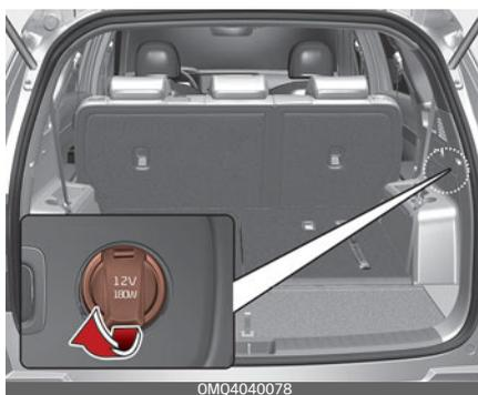
В автомобиле с заведенным двигателем электроприборы должны потреблять ток не более 15 А.
