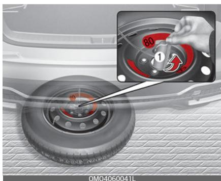
5. После того как запасное колесо ляжет на землю, продолжайте вращать балонный ключ против часовой стрелки, извлеките запасное колесо из-под автомо-
