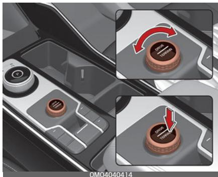
Переключиться из режима «DRIVE» (Режим движения) в режим «TERRAIN» (Внедорожный режим) можно путем нажатия кнопки переключения режимов «DRIVE/TERRAIN» (Режим движения / Внедорожный режим) и выбора режима «SNOW» (Снег), «MUD» (Грязь) или «SAND» (Песок) поворотом ручки «TERRAIN MODE» (Внедорожный режим). При повторном нажатии кнопки «DRIVE/TERRAIN» (Режим движения / Внедорожный режим) автомобиль вернется в режим «DRIVE» (Режим движения).
