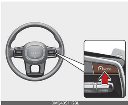
Для отключения системы круиз-контроля нажмите кнопку «Driving Assist» (Помощь при вождении) (⊙ MODE). Индикатор круиз-контроля (⊙ CRUISE) погаснет.
