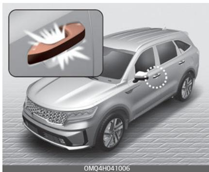
Когда все двери (в том числе дверь багажного отделения) заперты и закрыты, лампа ручки двери загорается примерно на 15 секунд при выполнении любого из следующих действий.
