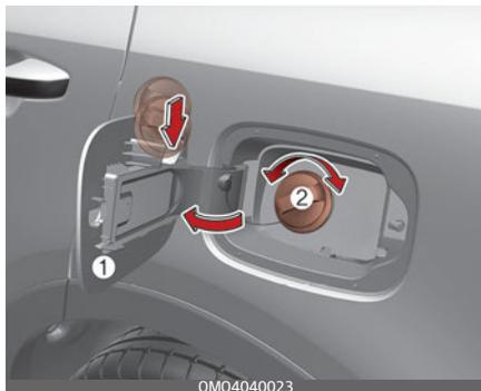
5. Чтобы снять крышку топливного бака (2), поверните ее против часовой стрелки. Вы можете услышать шипение из-за выравнивания давления в баке.
