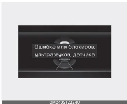
На приборной панели появится предупреждающее сообщение «Camera error or blockage» (Камера заблокирована или не работает) или «Ultrasonic sensor error or blockage» (Работа ультразвукового датчика ограничена) в следующих случаях:
