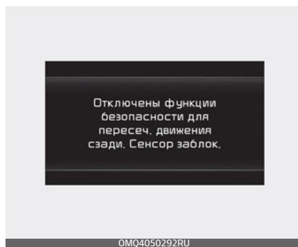
Если поверхность заднего бампера рядом с задним угловым радаром или датчиком покрыта посторонними веществами, например снегом или дождевой водой, или на автомобиле установлен прицеп либо навесной держатель, может снизиться качество обнаружения объектов. Кроме того, может быть временно ограничена функциональность системы безопасной высадки из автомобиля либо эта система может быть отключена.
