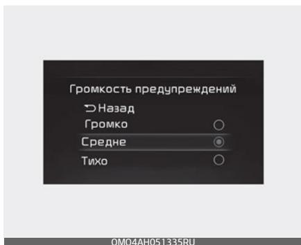
Чтобы изменить уровень громкости вспомогательной системы движения по автострате на «High» (Высокий), «Medium» (Средний), «Low» (Низкий) или «Off» (Выкл.), переведите кнопку «ENGINE START/STOP» (Запуск/остановка двигателя) в положение «ON» (Вкл.) и в меню «Settings» (Настройки) выберите пункт «Driver Assistance» (Помощь водителю) → «Warning Volume» (Громкость предупреждения).
