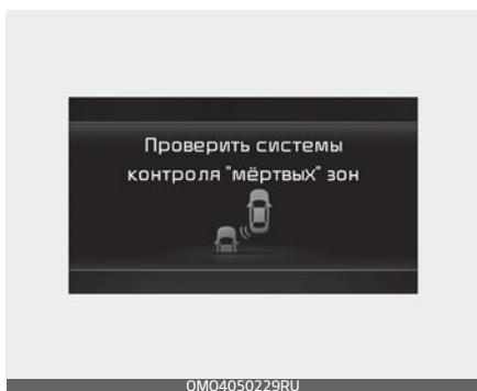
Если система безопасности в слепой зоне работает неправильно, на панели появится предупреждающее сообщение «Check Blind-Spot Safety system» (Проверьте систему безопасности в слепой зоне). При этом функция автоматически выключится либо ее действие будет ограничено. Проверьте работу функции у официального дилера Kia.
