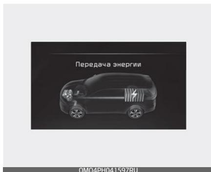
Двигатель используется для приведения автомобиля в движение и одновременно с этим для зарядки аккумулятора высокого напряжения.
