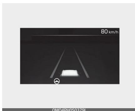
Если впереди обнаружено транспортное средство или обе разметки полосы движения, причем скорость вашего автомобиля ниже 200 км/ч (120 миль/ч), на приборной панели включится зеленый индикатор (🚗), а функция поможет автомобилю оставаться на полосе, управляя рулевым колесом.
