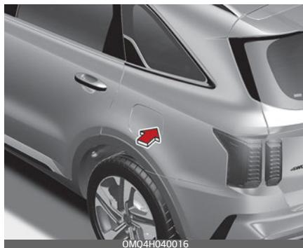
4. Потяните лючок горловины топливного бака (1), чтобы открыть его полностью.
