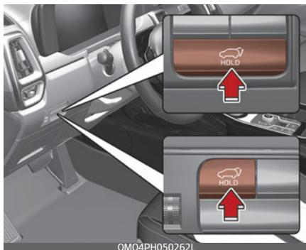
2. Переключатель ручки двери багажного отделения с электроприводом
