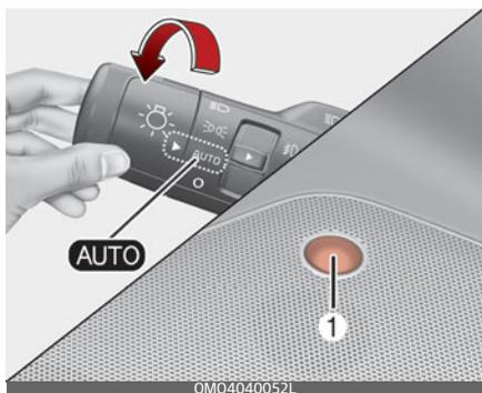
Если переключатель освещения установлен в положение «AUTO», задние габаритные огни и передние фары будут автоматически включаться или выключаться в зависимости от количества света снаружи транспортного средства.
