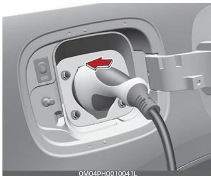
Затем вставьте его в гнездо зарядки до характерного щелчка. В результате неполного или неправильного соединения разъема зарядного кабеля и контактов зарядки может возникнуть возгорание.
