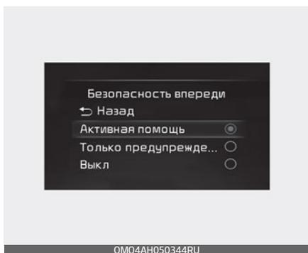
Переведите кнопку «ENGINE START/STOP» (Запуск/остановка двигателя) в положение «ON» (Вкл.) и в меню «Settings» (Настройки) выберите пункт «Driver Assistance» (Помощь водителю) → «Forward Safety» (Безопасность впереди), чтобы включить или отключить эти функции.
