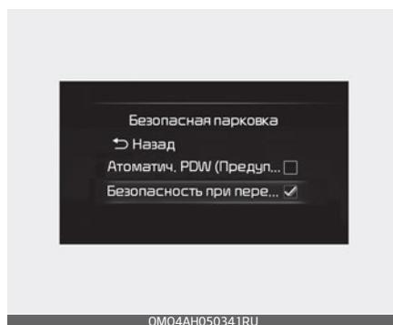
Переведите кнопку запуска/остановки двигателя в положение «ON» и в меню «Settings» (Настройки) выберите «Driver Assistance» (Помощь водителю) → «Parking Safety» (Безопасность парковки) → «Rear Cross-Traffic Safety» (Безопасность при пересеченном движении сзади), чтобы включить функцию предотвращения столкновения с объектами, движущимися в поперечном направлении позади автомобиля, или снимите флажок, чтобы отключить ее.
