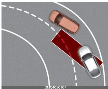
Система контроля «мертвых» зон может работать некорректно при движении по извилистой дороге. Функция может распознать автомобиль, движущийся в той же полосе, что и ваш автомобиль.
