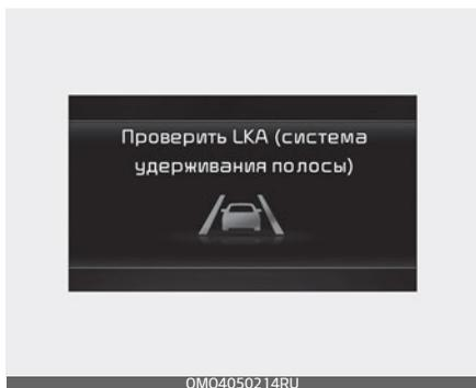
Если система удержания на полосе не работает должным образом, на приборной панели появится предупреждающее сообщение и загорится желтый индикатор (🚗). В этом случае проверьте работу функции у официального дилера Kia.
