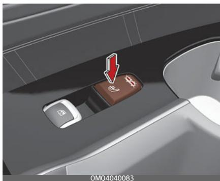
Переключите замок зажигания или кнопку «ENGINE START/STOP» (запуск/остановка двигателя) в положение «Вкл.»:
