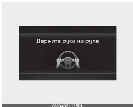
Если водитель снимет руки с рулевого колеса на несколько секунд, появится предупреждающее сообщение «Keep hands on the steering wheel» (Не отпускайте рулевое колесо) и прозвучит несколько предупреждающих звуковых сигналов.
