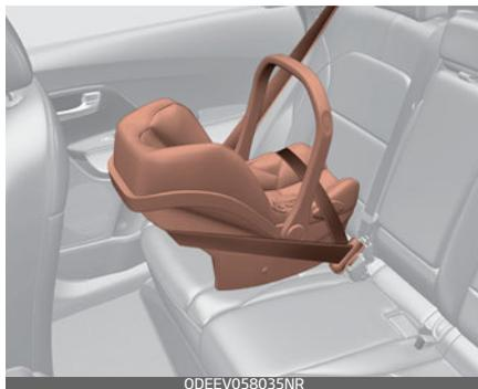
Детская удерживающая система с расположением против хода движения обеспечивает удерживание с помощью поверхности, на которую опирается спина ребенка. Система ремней удерживает ребенка на месте, а во время дорожно-транспортного происшествия удерживает его в детской удерживающей системе, снижая нагрузку на хрупкую шею и позвоночник.
