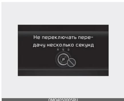
При повторном нажатии передачи «Р» (Парковка) либо перегреве трансмиссии на ЖК-дисплее появится сообщение.
