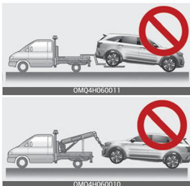
При буксировании полноприводного автомобиля его колеса не должны касаться земли. Автомобиль нужно буксировать с помощью колесного подъемника и тележек или безбортовой платформы, так чтобы все колеса были подняты над землей.
