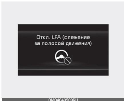
Если после предупреждения об отсутствии рук на руле водитель не поместит руки на руль, появится предупреждающее сообщение «Lane Following Assist (LFA) canceled» (Система слежения за полосой движения выключена) и система слежения за полосой движения автоматически отключится.
