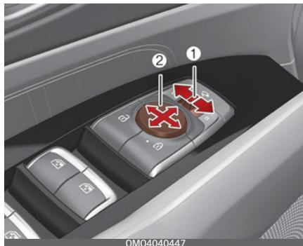
Регулировка наружных зеркал заднего вида.
