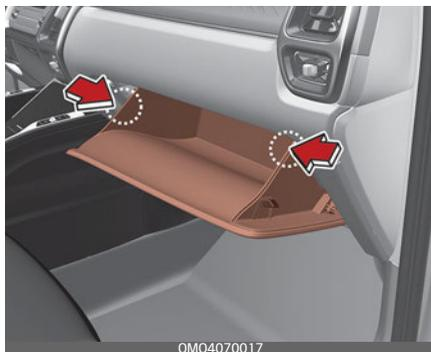
3. Снимите крышку фильтра системы климат-контроля, потянув за крышку с обеих сторон.
