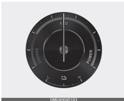
Указатель гибридной системы показывает, соблюдается ли при текущих условиях движения принцип экономичного расхода топлива.
