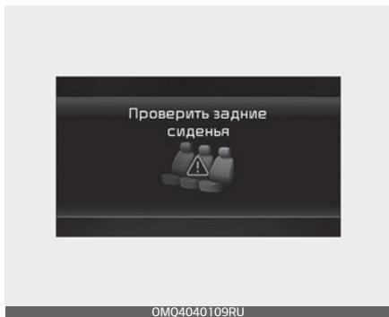
Вы можете активировать или деактивировать ROA в режиме установок на ЖК-дисплее приборной панели. Если автомобиль оснащен информационно-развлекательной системой, водитель может научиться, как настраивать параметры на веб-сайте перейдя, по QR-коду в кратком справочном руководстве по информационно-развлекательной системе.
