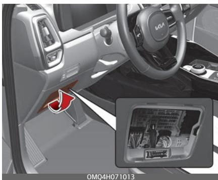
3. Извлеките предположительно неисправный предохранитель. Для этого воспользуйтесь специальным приспособлением, которое находится в основной блоке предохранителей в моторном отсеке.
