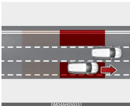
Вспомогательная система предотвращения столкновения в слепой зоне обнаруживает автомобиль в непросматриваемой зоне и предупреждает об этом водителя.
