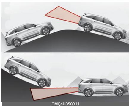
Система контроля «мертвых» зон может работать некорректно при движении на уклоне. Функция может не обнаружить автомобиль на соседней полосе или неправильно обнаружить землю или здание.
