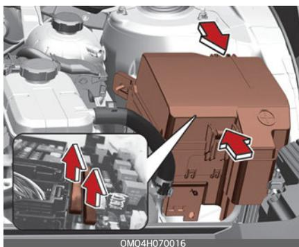
Если основной предохранитель перегорел, его следует извлечь следующим образом.
