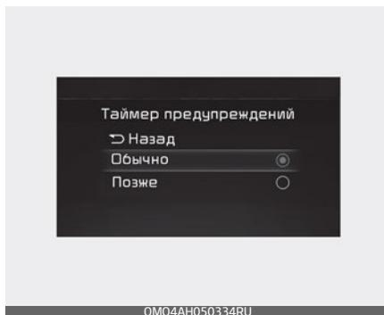
Чтобы изменить время срабатывания первоначального предупреждения системы контроля слепых зон, переведите кнопку «ENGINE START/STOP» (Запуск/остановка двигателя) в положение «ON» (Вкл.) и в меню «Settings» (Настройки) выберите пункт «Driver Assistance» (Помощь водителю) → «Warning Timing» (Таймер предупреждения).
