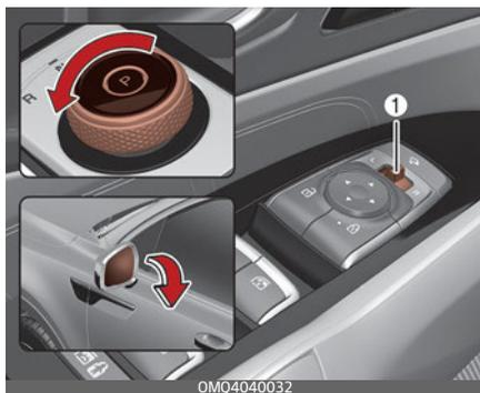
Положение переключателя наружного зеркала заднего вида (1) определяет, будут ли зеркала двигаться или нет.
