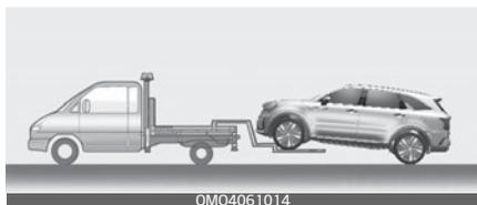
Потяните рычаг переключения передач в положение N (нейтраль), чтобы буксировать автомобиль, когда его колеса находятся на земле. Подробнее см. в разделе "Как оставаться в режиме «N» (нейтраль) при выключенном двигателе" на странице 6–22.
