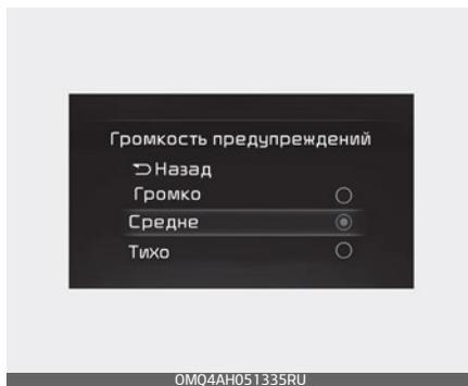
Когда кнопка «ENGINE START/STOP» (Запуск/остановка двигателя) находится в положении «ON» (Вкл.), выберите «Driver Assistance» (Помощь водителю) → «Warning Volume» (Громкость предупреждений) в меню «Settings» (Настройки), чтобы изменить громкость предупреждений для интеллектуальной системы дистанционной парковки, выбрав одно из значений: «High» (Высокая), «Medium» (Средняя), «Low» (Низкая) или «Off» (Выкл.).
