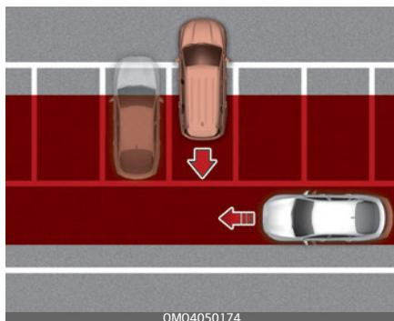
Функция предотвращения столкновения с объектами, движущимися в поперечном направлении позади автомобиля, может обнаруживать транспортные средства, проезжающие сзади вас, когда вы паркуетесь задним ходом на парковочное место. Если это произойдет, функция не всегда может выдавать предупреждение водителю и применять тормозную систему. Всегда следите за окружающей обстановкой при движении задним ходом.
