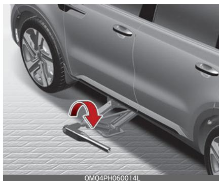
9. Ослабьте гайки колеса и снимите их пальцами. Снимите колесо со шпилек и положите его плашмя на землю, чтобы оно не укатилось. Чтобы установить на ступицу запасное колесо, совместите отверстия в диске со шпильками и посадите на них колесо.
