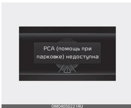
Если система предотвращения столкновения при парковке задним ходом или другие связанные с ней системы работают неправильно, на приборной панели появится предупреждающее сообщение «Check Parking Collision-Avoidance Assist system» (Проверьте систему предотвращения столкновения при парковке задним ходом) и система автоматически отключится. Следует провести осмотр автомобиля у официального дилера Kia.
