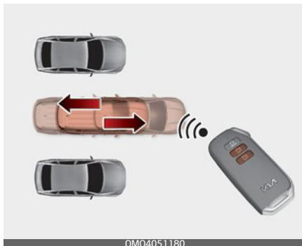
1. Нажмите и удерживайте кнопку «Вперед» (⏪) или «Назад» (⏩) на электронном ключе. Интеллектуальная система дистанционной парковки будет автоматически управлять рулевым колесом, скоростью автомобиля и коробкой передач. Автомобиль будет двигаться в направлении, заданном нажатой кнопкой.
