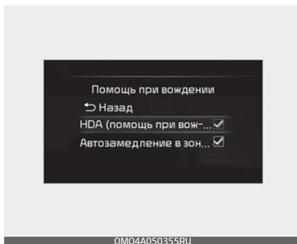
Переведите кнопку «ENGINE START/STOP» (Запуск/остановка двигателя) в положение «ON» (Вкл.) и в меню «Settings» (Настройки) выберите «Driver Assistance» (Помощь водителю) → «Driving Assist» (Помощь при вождении) → «Highway Auto Speed Change» (Автоматическое изменение скорости на автостраде), чтобы включить интеллектуальную систему круиз-контроля на основе данных навигации, и отмените выбор для ее отключения.
