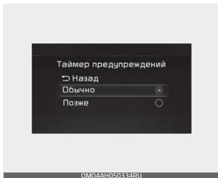
Переведите кнопку «ENGINE START/STOP» (Запуск/остановка двигателя) в положение «ON» (Вкл.) и в меню «Settings» (Настройки) выберите пункты «Driver Assistance» (Помощь водителю) → «Warning Timing» (Таймер предупреждений), чтобы изменить первоначальную скорость выдачи предупреждений системы предотвращения столкновения с объектами, движущимися в поперечном направлении позади автомобиля.
