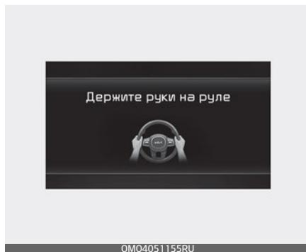
Если водитель снимет руки с рулевого колеса на несколько секунд, появится предупреждающее сообщение «Keep hands on steering wheel» (Не отпускайте рулевое колесо) и прозвучит несколько предупреждающих звуковых сигналов.
