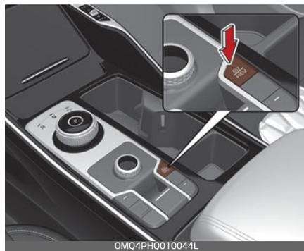
При нажатии на кнопку [EV/HEV] подключаемые гибридные режимы будут изменяться последовательно в таком порядке:
