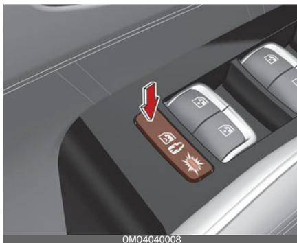
Чтобы отключить электронную систему блокировки для защиты от детей, еще раз нажмите переключатель этой системы, при этом
