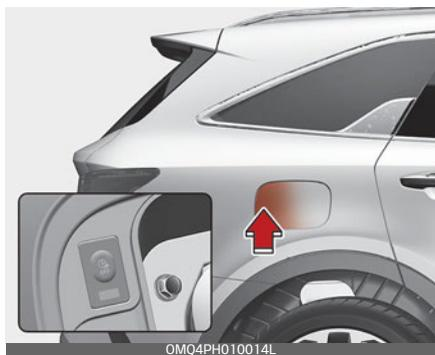
Статус зарядки можно проверить снаружи автомобиля во время зарядки или при использовании (это не статус режима движения) высоковольтного аккумулятора.
