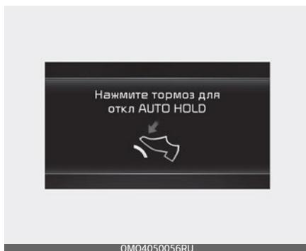
Если при нажатии кнопки «AUTO HOLD» (Автоматическое удержание) дверь водителя, дверь багажника или капот двигателя не закрыты, прозвучит предупреждающий сигнал, а на ЖК-дисплее отобразится соответствующее сообщение.
