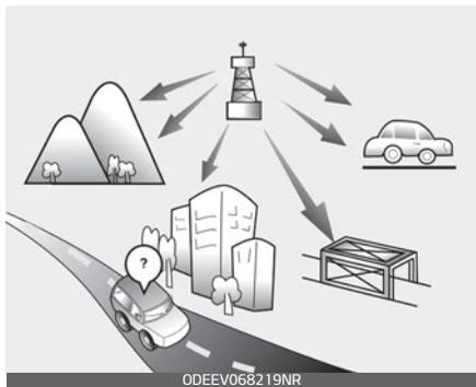
FM-радиосигналы передаются на высоких частотах и не следуют за профилем земной поверхности. По этой причине FM-сигналы начинают исчезать на небольшом расстоянии от радиостанции. Кроме того, на качество FM-сигналов могут влиять здания, возвышенности и другие препятствия. Это может приводить к созданию нежелательных и некомфортных условий прослушивания радио, в которых пользователь может подумать, что радиоприемник неисправен.
