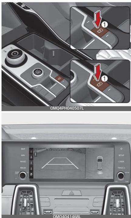
Камера кругового обзора служит для помощи при парковке, позволяя водителю видеть обстановку вокруг автомобиля.
