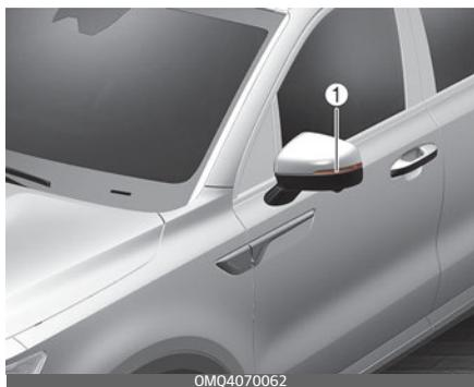
1. Боковой повторитель указателя поворота (светодиодная лампа)
