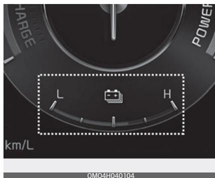
Этот индикатор показывает оставшийся заряд гибридного аккумулятора. Если уровень заряда близок к отметке L (Низкий), автомобиль автоматически подключает двигатель для зарядки аккумулятора.
