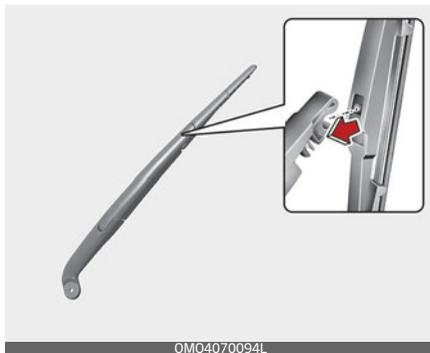
По завершении замены опустите направляющую стеклоочистителя на заднее стекло, включите зажигание и проверьте работу стеклоочистителей, чтобы убедиться в правильности установки щетки.
