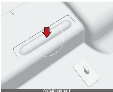
Номер VIN также указан на табличке, прикрепленной к верхней части приборной панели (при наличии). Номер, нанесенный на пластинку, виден снаружи через ветровое стекло.
