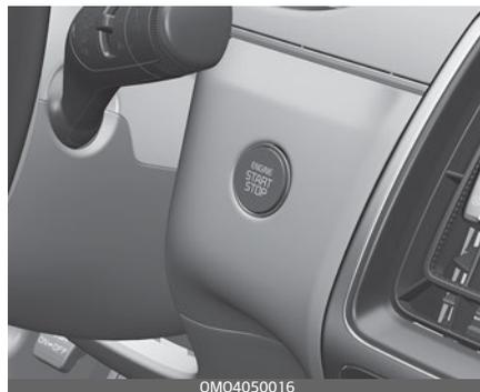
Подсветка гаснет примерно через 30 секунд после закрывания двери. Она также гаснет сразу же при срабатывании системы противоугонной сигнализации.
