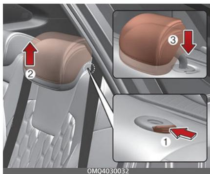
Чтобы снять подголовник, поднимите его как можно выше, а затем нажмите кнопку фиксатора (1),
