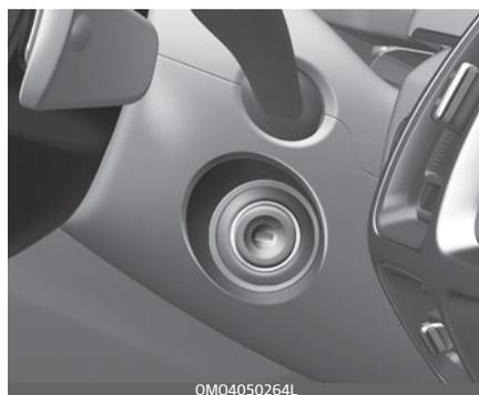
Подсветка гаснет сразу после включения зажигания. Подсветка также гаснет примерно через 30 секунд после закрывания двери.
