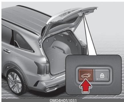
4. Кнопка блокирования двери багажника с электроприводом
