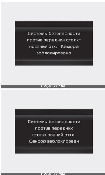
Если лобовое стекло, на котором расположена камера переднего вида, крышка переднего радара или датчик засыпаны снегом или залиты дождем, качество обнаружения может снизиться. Кроме того, это может привести к временному ограничению работоспособности или отключению вспомогательной функции предотвращения лобового столкновения (Forward Collision-Avoidance Assist).
