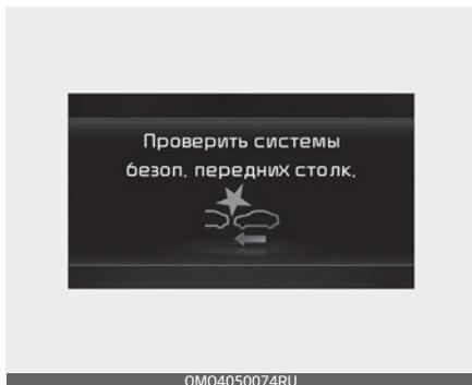
Если система помощи по предотвращению лобового столкновения не работает надлежащим образом, на приборной панели будет выведено предупреждающее сообщение и загорятся сигнальные лампы (⚠) и (🚗). Проверьте работу функции у официального дилера Kia.
