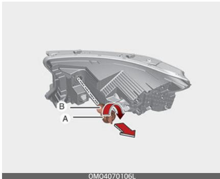
3. Извлеките лампу (В) из патрона (А), вдавив ее и повернув против часовой стрелки до положения, в котором ее выступы совместятся с прорезями в патроне. Выньте лампу из патрона.
