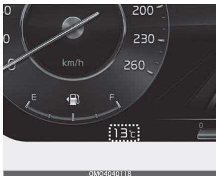
Этот индикатор показывает текущую температуру наружного воздуха с точностью до 1 °C (1 °F).
