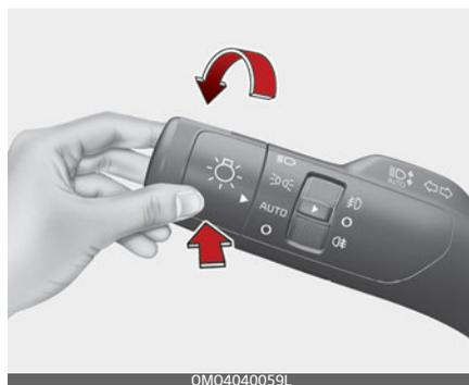
Система автоматического переключения фар дальнего света — это функция, которая автоматически регулирует дальность света фар (осуществляет переключение между режимами ближнего и дальнего света фар) в зависимости от яркости света от других автомобилей и дорожных условий.
