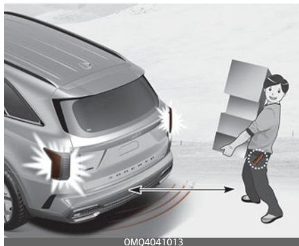
Если вы находитесь в зоне обнаружения (50–100 см (20–40 дюйм) за автомобилем) и у вас при себе есть электронный ключ, мигает аварийная сигнализация и подается звуковой сигнал, которые предупреждают вас, что система определила электронный ключ и багажник откроется.
