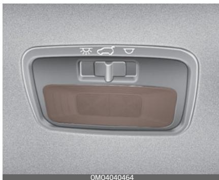
Если лампа багажного отделения (накаливания/светодиодная) не работает, рекомендуется проверить систему в специализированной мастерской.
