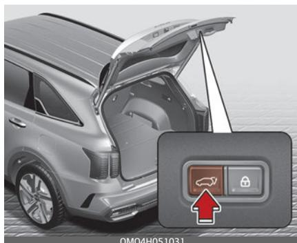
Дверь багажного отделения закрывается автоматически.
