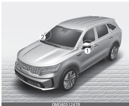
(камера, расположенная в нижней части зеркала)
