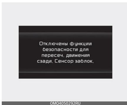
Если поверхность заднего бампера рядом с задним угловым радаром или датчиком покрыта каким-либо веществом, например слоем снега или льда, или на автомобиле установлен прицеп либо навесной дер-
