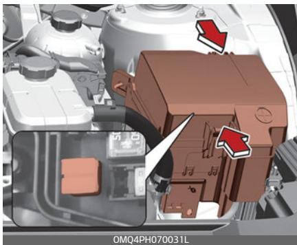
4. Проверьте извлеченный предохранитель и замените его в случае неисправности. Запасные предохранители находятся в блоке предохранителей приборной панели (или в блоке предохранителей в моторном отсеке).
