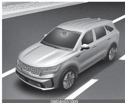
Камера переднего вида используется в качестве датчика обнаружения для определения уровня окружающего освещения и яркости во время управления автомобилем. Смотрите точное расположение датчика обнаружения на иллюстрации выше.
