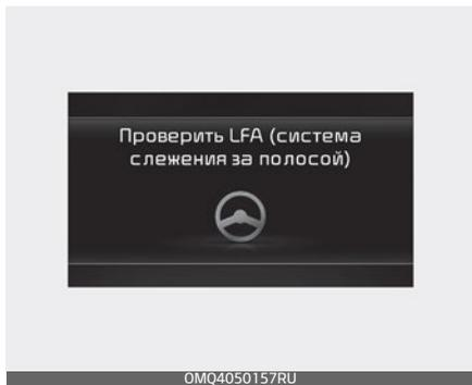
Если функция контроля полосы не работает должным образом, на приборной панели появится предупреждающее сообщение «Check Lane Following Assist (LFA) system» (Проверьте систему слежения за полосой движения (LFA)). В этом случае проверьте работу функции у официального дилера Kia.
