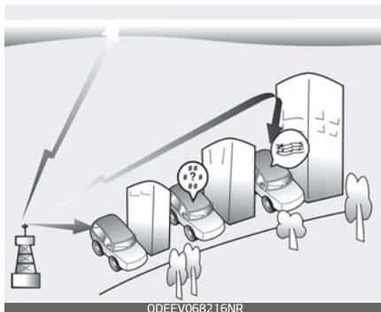
Передачу радиосигналов в диапазонах AM и FM осуществляют ретрансляционные вышки, расположенные вокруг населенных пунктов. Эти сигналы принимаются радиоантенной автомобиля. После этого сигнал поступает на радиоприемное устройство и передается на колонки автомобиля.
