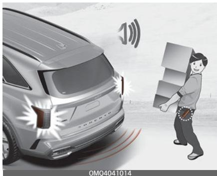
Мигают аварийные огни и 6 раз подается звуковой сигнал, после чего дверь багажного отделения открывается.
