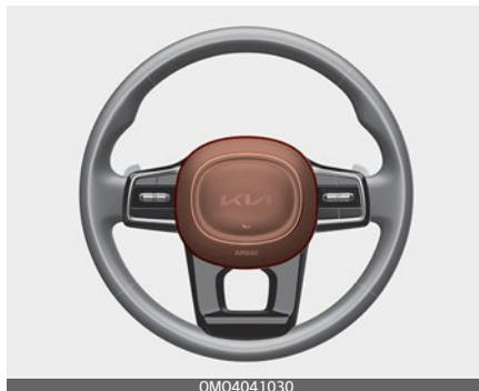
Звуковой сигнал сработает только при нажатии на эту область. Регулярно проверяйте звуковой сигнал, чтобы убедиться в его исправной работе.
