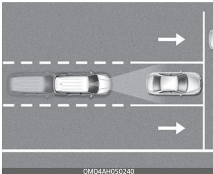
Вспомогательная функция предотвращения лобового столкновения помогает обнаруживать и отслеживать транспортные средства по ходу движения, обнаруживать пешеходов на проезжей части, а также предупреждает водителя о возможном столкновении с помощью предупреждающего сообщения и звукового оповещения и при необходимости применения экстренного торможения.
