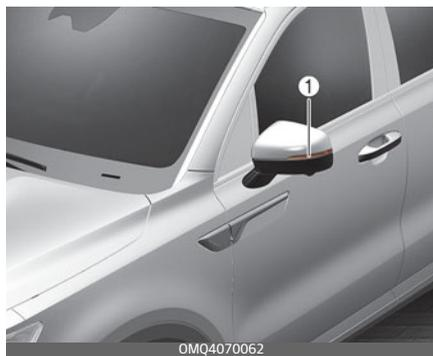
Если лампа бокового повторителя указателя поворота (светодиодный) (1) не работает, следует про-
