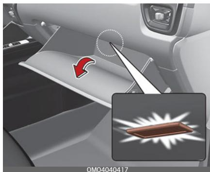
Лампа освещения перчаточного ящика загорается при его открытии.
