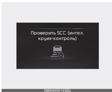
Если система интеллектуального круиз-контроля работает неправильно, появится предупреждающее сообщение «Check Smart Cruise Control system» (Проверить систему интеллектуального круиз-контроля) и на приборной панели загорится сигнальная лампа (⚠️). Проверьте работу функции у официального дилера Kia.
