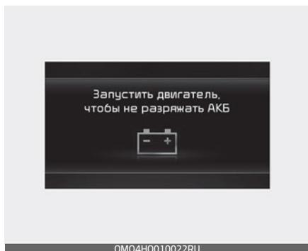
Аккумулятор может разрядиться, если не включать двигатель с помощью кнопки запуска/остановки двигателя в доп. устройствах, или если он включается на непродолжительное время. Чтобы аккумулятор 12 В не разряжался, необходимо включать двигатель.
