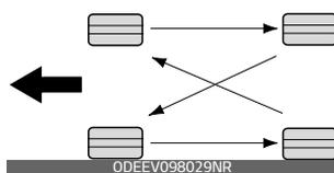
Шины с направленным рисунком протектора (при наличии)
