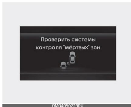
Если вспомогательная система обеспечения безопасного выхода работает неправильно, на панели появится предупреждающее сообщение «Check Blind-Spot Safety system» (Проверьте систему безопасности в слепой зоне). При этом функция автоматически выключится либо ее действие будет ограничено. Проверьте работу функции у официального дилера Kia.
