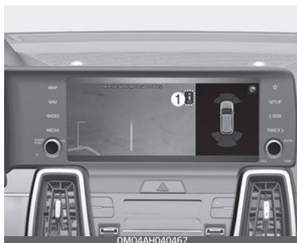
Если нажать на пиктограмму (1), на экране появится вид сверху, на котором будет показано расстояние до задней части автомобиля во время парковки.
