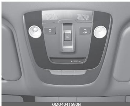
Люком можно управлять только тогда, когда переключатель зажигания или кнопка «Engine Start/Stop» (запуск/останов двигателя) находится в положении «ON» (Вкл.) или «START» (пуск).
