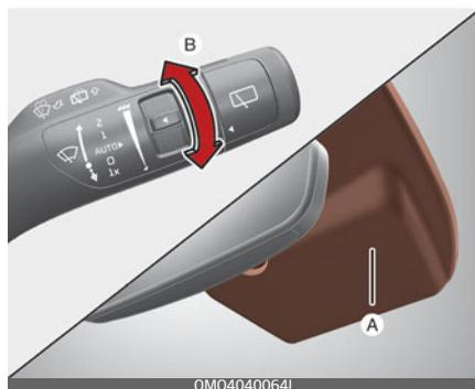
Датчика дождя (А), расположенный на верхней части лобового стекла, определяет количество осадков и регулирует интервал цикла очистки стекла. Чем сильнее становится дождь, тем быстрее работает стеклоочиститель. Когда дождь прекращается, стеклоочиститель останавливается.
