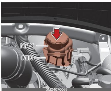
1. Перед снятием крышки бачка и добавлением тормозной жидкости тщательно очистите зону вокруг крышки бачка для предотвращения загрязнения тормозной жидкости.
