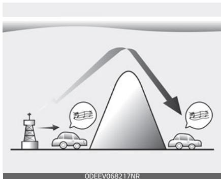
Прием радиосигналов в диапазоне AM возможен на большем расстоянии по сравнению с радиосигналами в диапазоне FM. Это связано с тем, что AM-радиоволны передаются на низких частотах. Это длинные низкочастотные радиоволны огибают изогнутый профиль земной поверхности, а не передаются по прямой. Кроме того, они обходят препятствия, что обеспечивает увеличение зоны охвата.
