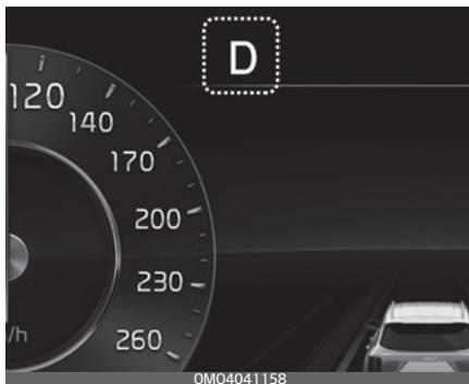
Этот индикатор показывает, какое положение рычага автоматической коробки передач выбрано.
