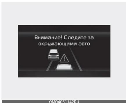
В перечисленных ниже условиях на приборной панели отобразится предупреждение «Watch for surrounding vehicles» (Следите за окружающими транспортными средствами) и прозвучит звуковое сообщение для оповещения водителя о дорожных условиях по ходу движения.
