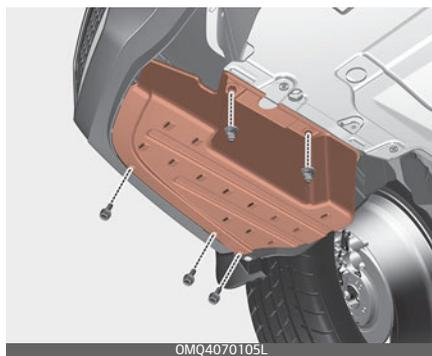
3. Ослабьте пластиковые фиксирующие винты и снимите крышку под панелью.
