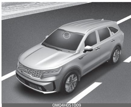
Камера переднего вида используется в качестве датчика обнаруже-
