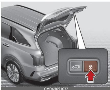
5. Кнопка открытия двери багажного отделения с электроприводом
