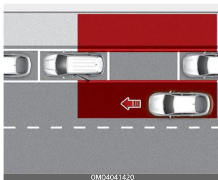
Если после остановки автомобиля и открытия пассажирской двери будет обнаружено приближающееся сзади транспортное средство, система контроля безопасного выхода предупредит водителя с помощью сообщения и звукового сигнала, чтобы предотвратить столкновение.
