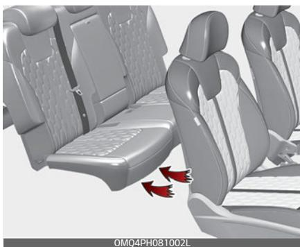
Вентиляционный воздуховод гибридного аккумулятора расположен под передними сиденьями с правой стороны. Вентиляционный воздуховод охлаждает гибридный аккумулятор. Если вентиляционный воздуховод гибридного аккумуля-
