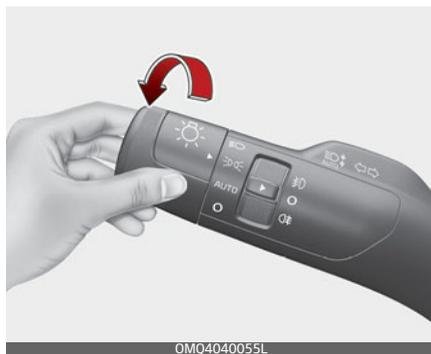
Если переключатель наружного освещения находится в положении габаритных огней, включаются передние габаритные огни, задние габаритные огни и лампа освещения номерного знака.
