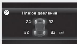
1. Сигнал низкого давления в шинах / индикатор неисправности системы TPMS.
