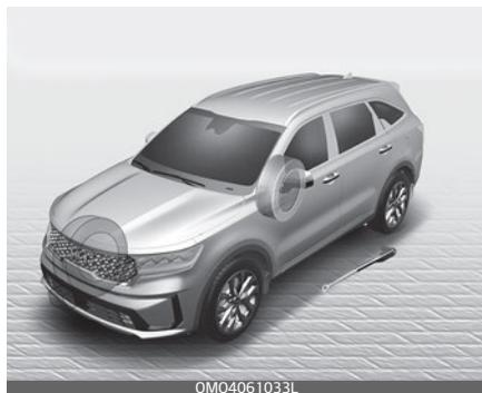
4. Достаньте колесный гаечный ключ, домкрат запасное колесо из автомобиля.
