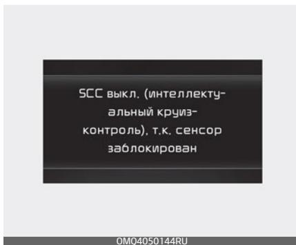
Если крышка переднего радара или датчик покрыты каким-либо веществом, например снегом или дождем, возможно ухудшение качества обнаружения объектов, а также временное ограничение функциональности или отключение системы интеллектуального круиз-контроля.
