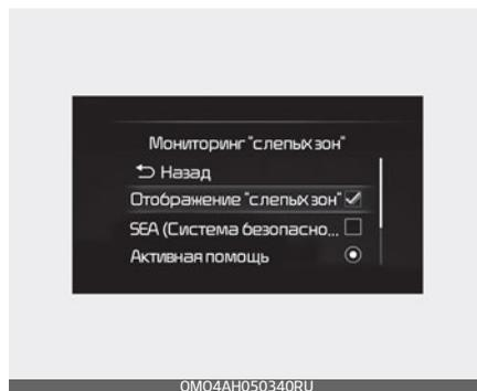
Когда кнопка запуска/остановки двигателя находится в положении «Вкл.», выберите в меню «Настройки» пункт «Помощь водителю» → «Blind-Spot Safety» (Мониторинг слепых зон) → «Blind Spot View» (Отображение «слепых зон»), чтобы включить монитор отображения «слепых зон», и отметьте выбор для отключения системы.
