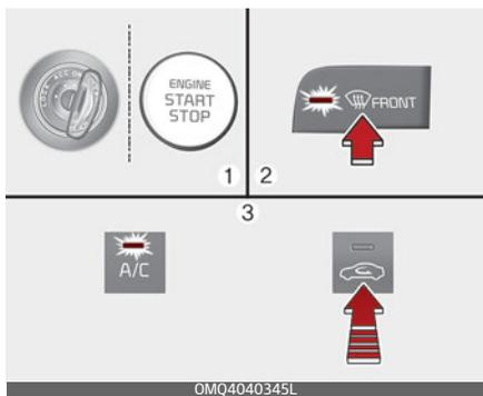
1. Переведите кнопку «ENGINE START/STOP» (Запуска/остановки двигателя) в положение «ON» (Вкл.).
