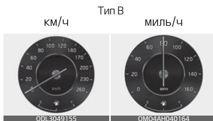
Спидометр показывает скорость автомобиля в километрах в час (км/ч) и в милях в час (миль/ч).
