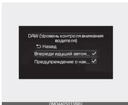
Переведите кнопку «ENGINE START/STOP» (Запуск/остановка двигателя) в положение «ON» (Вкл.) и в меню «Settings» (Настройки) выберите пункт «Driver Assistance» (Помощь водителю) → «Driver Attention Warning» (Система контроля внимания), чтобы включить или отключить эти функции.
