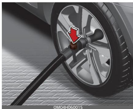
4. Открутите колпачок с ниппеля неисправной шины и навинтите на него шланг от емкости с герметиком.
