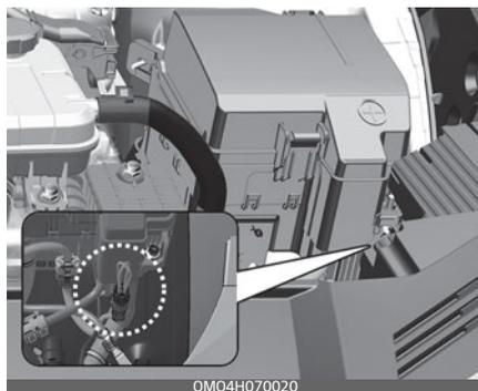
В аварийной ситуации перережьте кабель сервисного блокировочного разъема, чтобы изолировать высокое напряжение аккумулятора.
