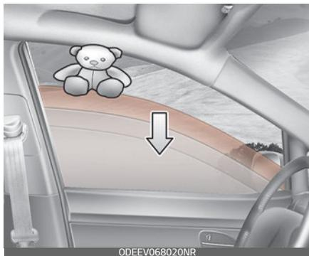
Если подъему окна препятствует какой-либо предмет или часть тела, система определяет наличие противодействия и прекращает движение. Затем окно опускается приблизительно на 30 см (11,8 дюйма), чтобы можно было вынуть объект, попавший между стеклом и рамой окна.
