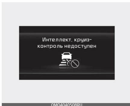
Если нажать кнопку помощи при вождении (MODE), задействовать переключатель «+», «-» или (|| ☺) в ситуации, когда условия работы функции не выполняются, на приборной панели появится предупреждающее сообщение «Smart Cruise Control conditions not met» (Не выполняются условия работы системы интеллектуального круиз-контроля) и прозвучит звуковой сигнал.
