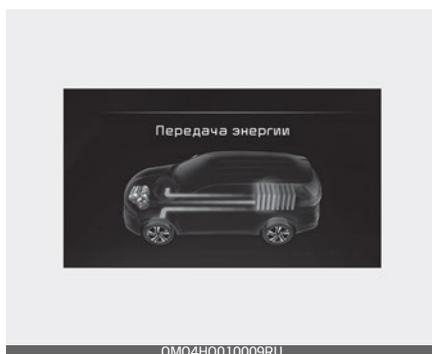
Двигатель заряжает аккумулятор высокого напряжения. Энергия электромотора используется для приведения автомобиля в движение.
