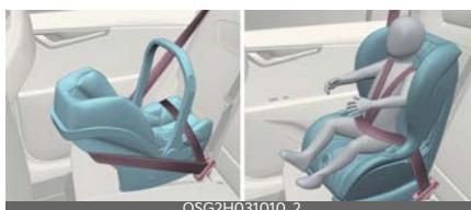
Atgal atgręžtoje vaiko apsaugos siste- moje užtikrinama, kad prisegto vaiko nugara remtysi į sédimajį paviršių. Diržų sistema sulaiko vaiką vietoje, o nelai- mingo atsitikimo atveju padeda išlaikyti vaiką vaiko tvirtinimo sistemoje ir sumažinti įtampą trapiam kaklui ir nugaros smegenims.
