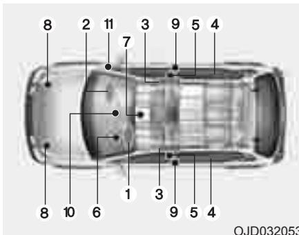
**Компоненты и функции системы SRS**
