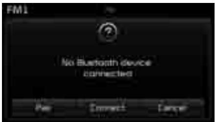
Если устройства с функцией *Bluetooth® Wireless Technology* сопряжены, но в настоящее время не подключены, то при нажатии на кнопку **PHONE** или кнопку на устройстве дистанционного управления на руле появится показанный ниже экран. Нажмите кнопку **[Pair]** (Сопряжение) для сопряжения нового устройства или нажмите **[Connect]** (Подключить) для подключения уже сопряженного устройства.
