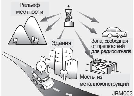
FM сигнал передается на высоких частотах и не искривляется, проходя вдоль поверхности Земли. Поэтому FM сигнал обычно начинает затухать на коротком расстоянии от радиопередающей станции. Кроме того FM сигналы легко нарушаются зданиями, горами и другими препятствиями. Это может привести к определенным состояниям при воспроизведении звука, которые могут выглядеть как неисправность радио. Указанные ниже состояния являются нормальными и не указывают на неисправность радио:
