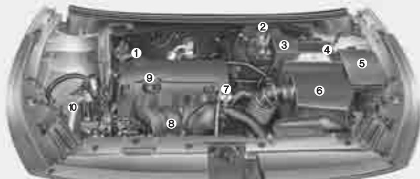
1. Крышка маслозаливной горловины двигателя
