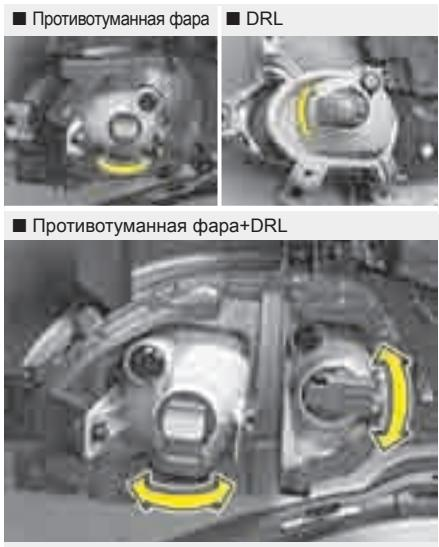
4. Извлеките патрон из корпуса, повернув его против часовой стрелки до совмещения выступов на патроне с прорезями корпуса.
