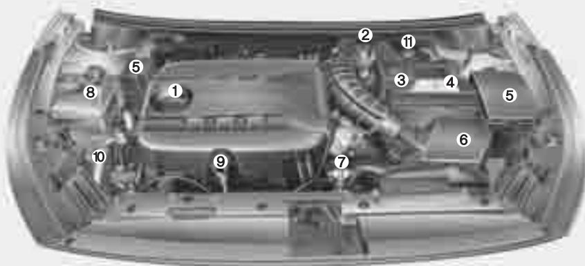
1. Крышка маслозаливной горловины двигателя
