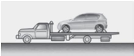
Рекомендуется использование колесных тележек или автомобиля с безбортовой платформой. Информацию по буксировке прицепа см. в разделе 5 «Буксировка прицепа».
