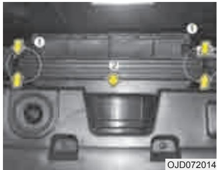
3. Снимите крышку, нажав фиксаторы с обеих сторон. Затем снимите фильтр системы климат-контроля.
