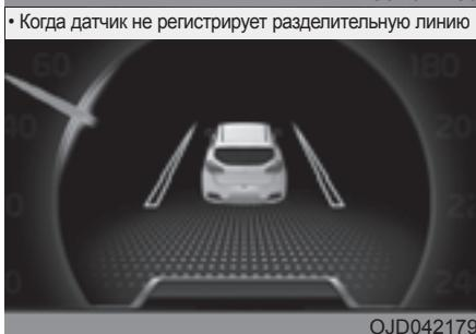
Если автомобиль покидает полосу движения, когда система LDWS включена и скорость превышает 60 км/ч, предупреждение работает следующим образом:
