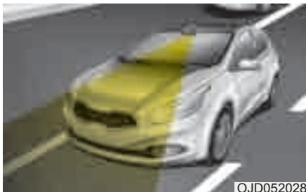
Данная система регистрирует полосу движения с помощью датчика на ветровом стекле и предупреждает водителя при выезде за полосу.
