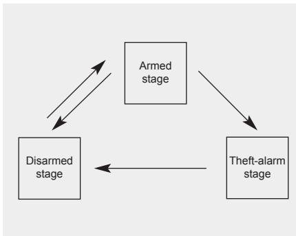
Эта система предназначена для защиты от несанкционированного проникновения в автомобиль. Эта система функционирует в три этапа – “Активированное состояние”, “Противоугонная сигнализация” и “Деактивированное состояние”. В случае срабатывания звучит сирена, сопровождаемая миганием огней аварийной сигнализации.
