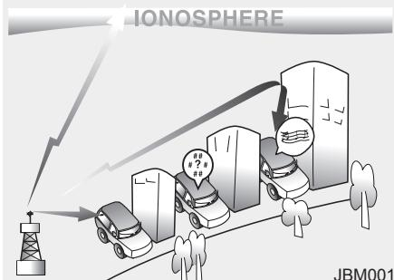
Это может быть обусловлено такими факторами, как расстояние до радиостанции, близость других радиостанций с сильным источником сигнала или наличие зданий, мостов и других крупных конструкций в зоне приема сигнала.
