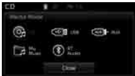
Если [Pop-up Mode] (Режим всплывающего окна) включен на **SETUP** ▶ [Display] (Дисплей), то при нажатии кнопки **MEDIA** будет отображаться всплывающий экран режима носителя.
